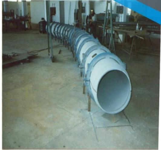
**Fabricación de encamisados para ductos de PEMEX, de ubicación marítima y terrestre, de diferentes diámetros y geometría. Tecnología del cliente MEXSSUB S.A. de C.V.**
