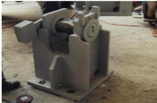
***Fabricación de mecanismo de levante de puerta para horno y componentes, montaje mecánico e instalación eléctrica, fuerza y control de horno (Rassini), cliente ABB S.A. de C.V.***
